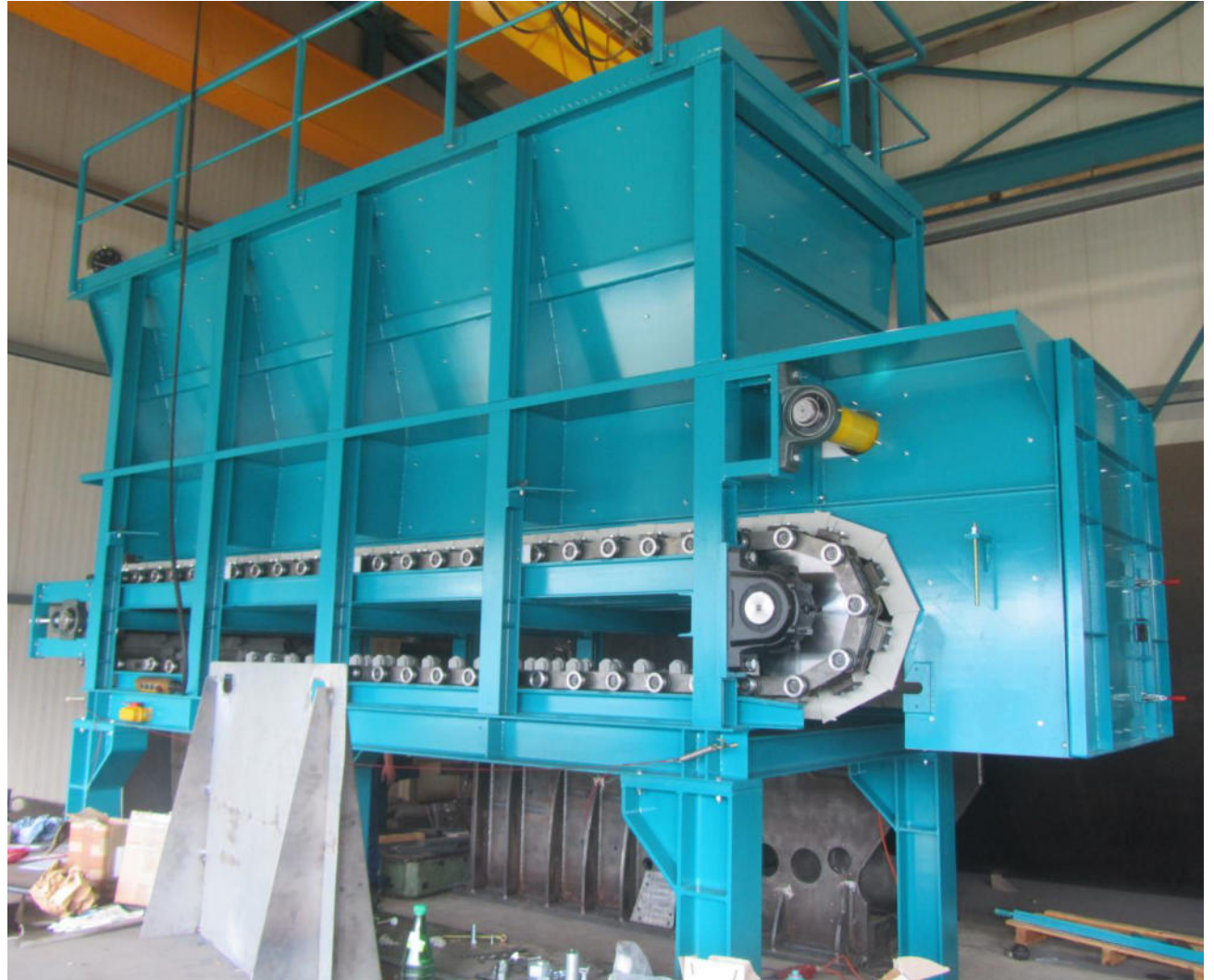
Kastenbeschicker für Tonaufbereitung, Shanghai
